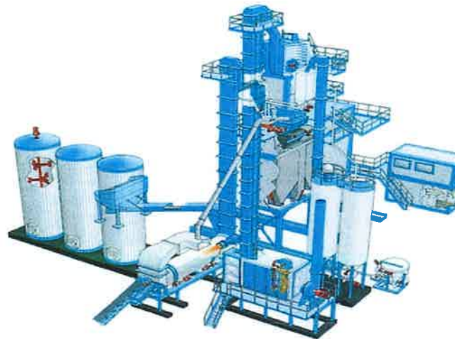
Rysunek 1. Schemat instalacji do produkcji mieszanki mineralno-asfaltowej
